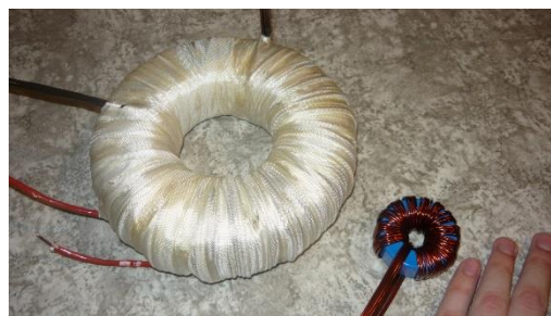
Obrázek č. 34: Transformátor a tlumivka
