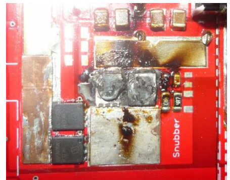
Obrázek č. 45: MPPT regulátor – Spálený můstek
